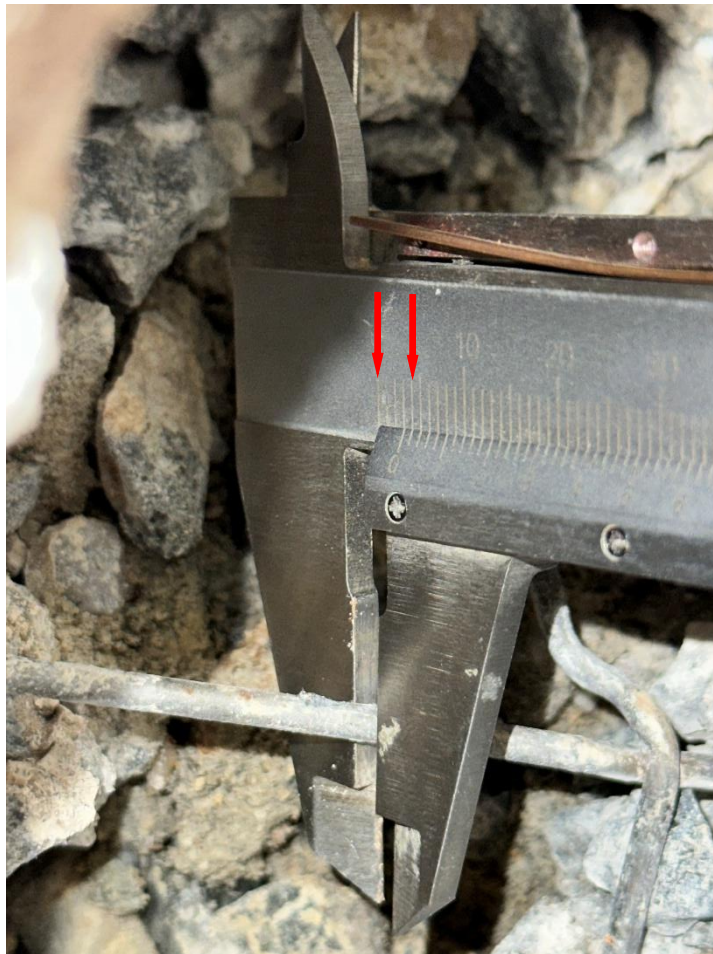
Figure 11 : Mesure du diamètre des treillis soudés du plancher bas RdC
