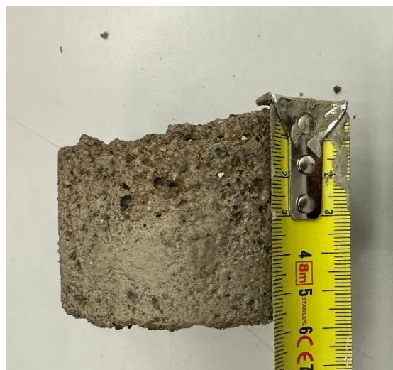
Figure 10 : Chape du plancher bas du RdC
